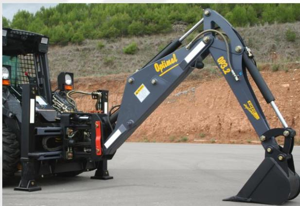
Brazo excavador con estabilizadores verticales de alto recorrido, pies flotantes, desplazamiento lateral del brazo. Ágil y potente, idóneo para labores de zanqueo, canalización, construcción, limpieza,... Acoplamiento muy sencillo rápido y efectivo. Operado desde dentro de la cabina lo que aporta mayor seguridad y velocidad de trabajo, con una visibilidad óptima. Materiales y componentes de primera calidad. Test individual hidráulico. Baldes con dientes y portadientes.
