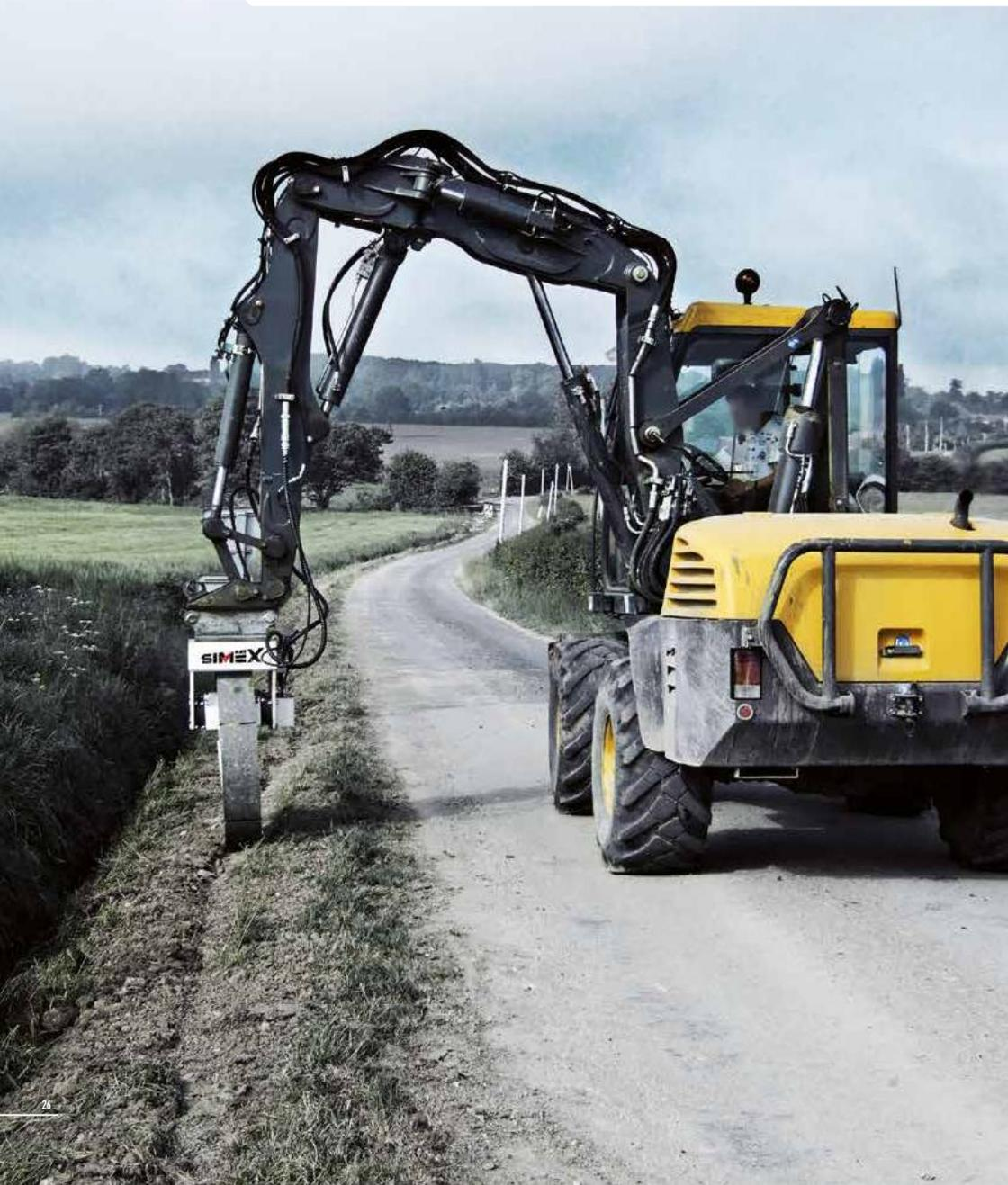
■ Diseñados para compactar el fondo de las excavaciones en sección, los compactadores de rueda vibratorios Simex CT, garantizan un fondo sólido, homogéneo y bien compactado, que no cede con el tiempo y permite la máxima seguridad en la circulación vial.
