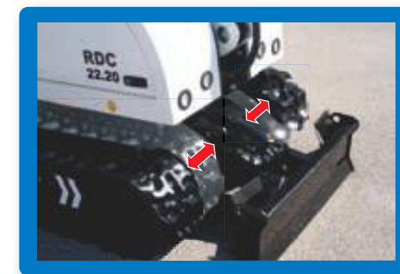
Carro ensanchable hidráulicamente Hydraulic extendable undercarriage
