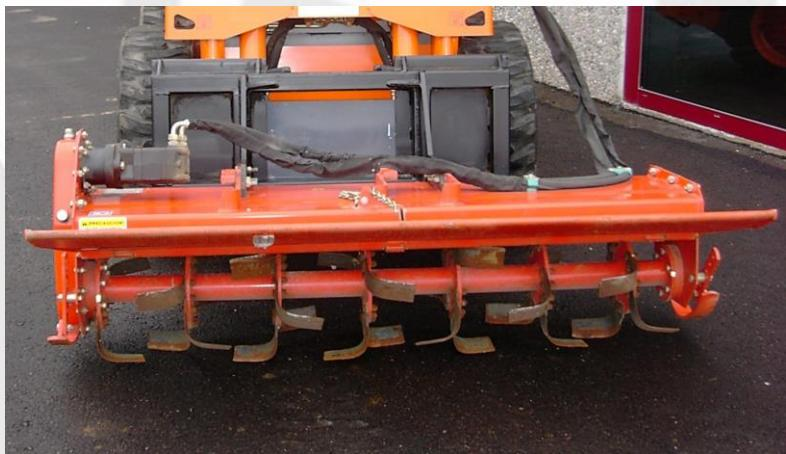
Accesorio fácilmente adaptable a su minicargadora. Se aplica especialmente en trabajos de jardinería para preparación de tierras antes de plantación y siembra; extirpador de malas hierbas, mezclador de tierras para mejorar la textura y aireación. La profundidad de trabajo se regula mediante patines y con la posición de la tapa regulable se consigue una mayor o menor pulverización del terreno.
