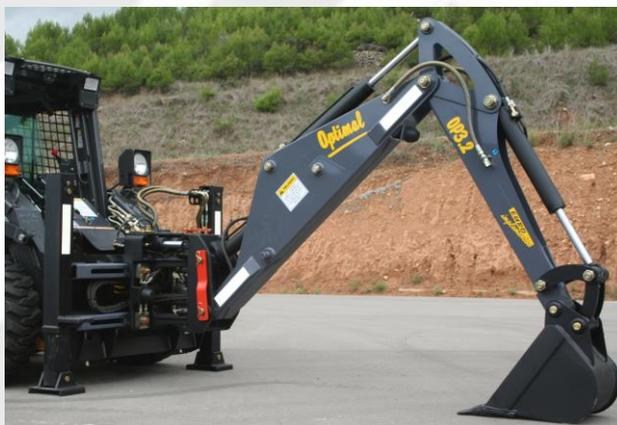
Brazo excavador con estabilizadores verticales de alto recorrido, pies flotantes, desplazamiento lateral del brazo. Ágil y potente, idóneo para labores de zanjeo, canalización, construcción, limpieza,... Acoplamiento muy sencillo rápido y efectivo. Operado desde dentro de la cabina lo que aporta mayor seguridad y velocidad de trabajo, con una visibilidad óptima. Materiales y componentes de primera calidad. Test individual hidráulico. Baldes con dientes y portadientes.
