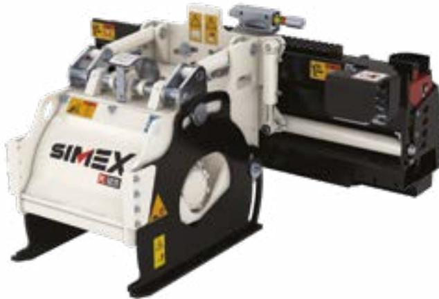
Las fresadoras viales autonivelantes Simex **retiran toda la capa de asfalto o cemento** en preparación de la sucesiva excavación o para el **escarificado de la superficie deteriorada** antes de hacer la rehabilitación. Creadas para **fresar secciones predefinidas** en superficies duras y compactas, permiten reutilizar el material escarificado para el sucesivo rellenado de la excavación.
