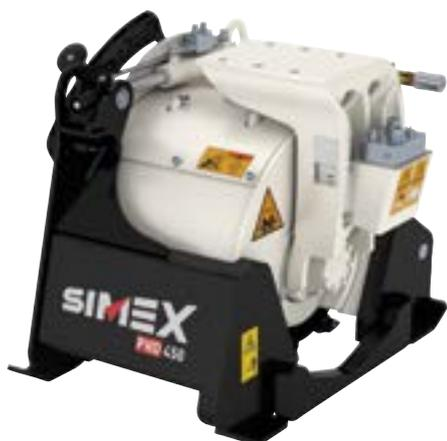
Diseñadas para **fresar secciones predefinidas** en superficies duras y compactas, las fresadoras para excavadora PLB y PHD **retiran toda la capa de asfalto o cemento** en preparación de la sucesiva excavación, o **para el escarificado de la superficie deteriorada antes** de hacer la rehabilitación.
