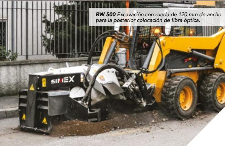
**RW 500** Excavación con rueda de 120 mm de ancho para la posterior colocación de fibra óptica.
